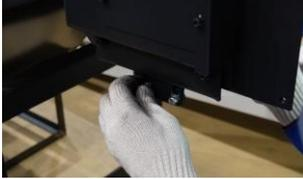
コンベヤにブラシホルダーを取付ける<br>ブラシホルダー固定の際は、ブラシがヒンジ面に当たるよう<br>にして固定してください。
